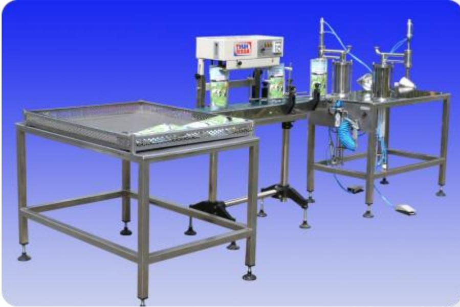
Полуавтомат **УФ-4.5** предназначен для фасовки жидких и пастообразных продуктов в заранее изготовленные многослойные ламинированные пакеты типа «дой-пак» с открытой верхней частью и последующей их запайки. Агрегат состоит из модуля запайщика с транспортером, стола фасовки и стола готовой продукции. На столе фасовки размещены два узла роздува пакетов, два дозирующих устройства, два приспособления для порционного ручного дозирования.
