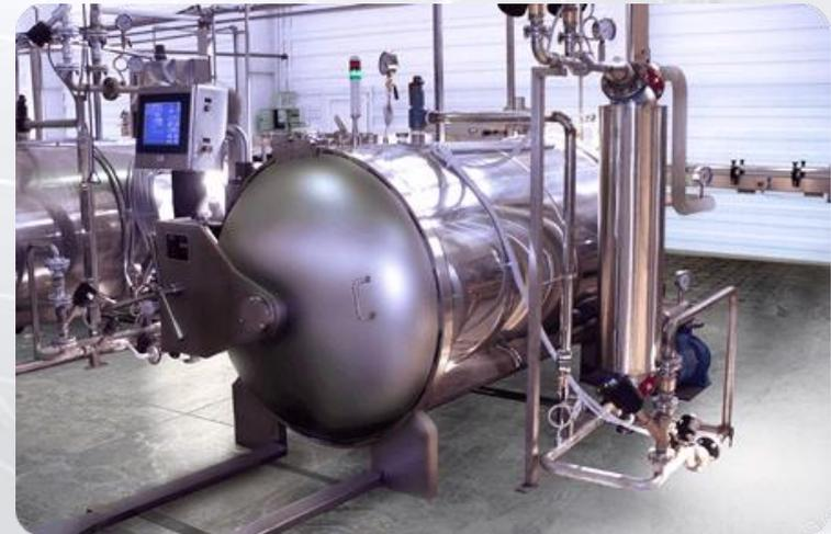
Отличительной особенностью автоклавов АГ-1200 является возможность производить расчет стерилизующего эффекта в режиме реального времени при измерении температуры продукта внутри баночки (упаковки). Это дает возможность технологу вносить корректировку в режимы стерилизации при проведении пусконаладочных работ и подготовки к производству новой продукции (или в новой упаковке).
