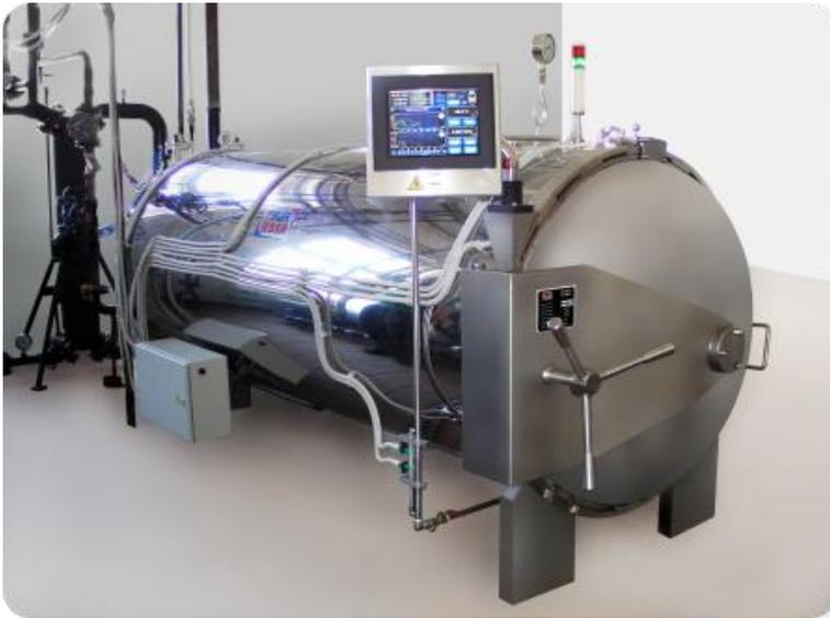
Автоклав горизонтального типа с байонетным затвором полностью из нержавеющей стали предназначен для стерилизации пищевых продуктов при температуре до 141 °С и при избыточном давлении до 0,3 Мпа и выпускаются четырех типоразмеров: на 1, 2, 3 или 4 контейнера. Весь процесс стерилизации полностью автоматизирован.
