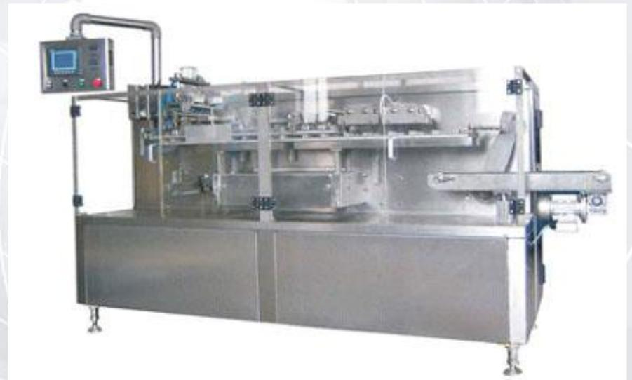
Автоматы **ДПМ20** и **ДПМ40** обеспечивают возможность фасовки и розлива различных продуктов в готовые пакеты дой-пак разной формы и размера.
